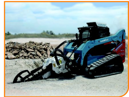
Копание траншеи в США
